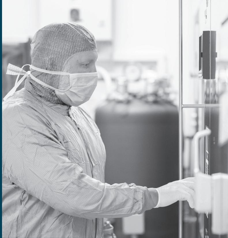
Bedienung der Anlage zur Gefriertrocknung in den Reinräumen der C<sup>+</sup>TBA in Krems an der Donau. Die Gefriertrocknung ist ein schonendes Verfahren zur Konservierung der Knochentransplantate.
